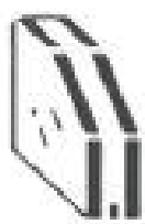
Doble cristal .4 mm cada uno. Con tratamiento térmico
