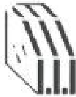
Triple cristal. 4 mm cada uno. Con tratamiento térmico
