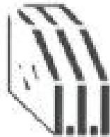
Triple cristal. 4 mm cada uno. Con tratamiento térmico
